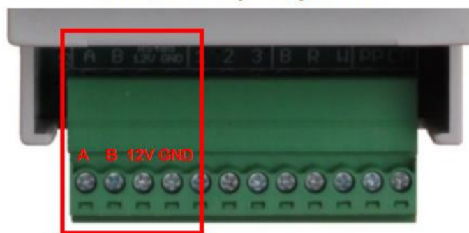
Svorkovnice řídící jednotky ve stanici
